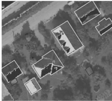
Abb. 9: Geeignete Solarflächen (dunkle Dachflächen - sehr gut, helle Dachflächen - gut)
